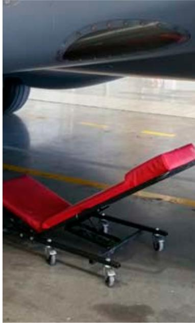
4. Tablero acolchado para trabajar sobre la A.P.U. igual al anterior en su calidad de básico pero muy necesario para facilitar el trabajo apoyado e inclinado sobre la unidad de potencia auxiliar. VER IMAGEN (4)
