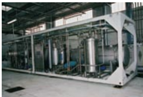
PLANTA COMPACTA PARA PRODUCIR BIODIESEL. Fuente: Fundación Terra
